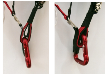
Abbildung 5: Außer des TEA Systems verfügt die Tragegurte über eine innere Schlaufe, um einen Ausgleich des Drehmomentes zu erreichen. Es ist im Gegensatz zum TEA System, wo eine Einstellmöglichkeit durch die Lage des Knotens gegeben ist, hier keine Justierung möglich.
